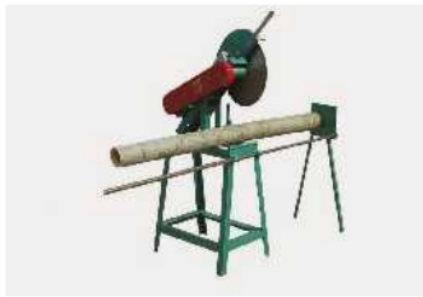
Gambar 1. Alat Pemotong Bambu dan Hasil Pemilihan Bambu
